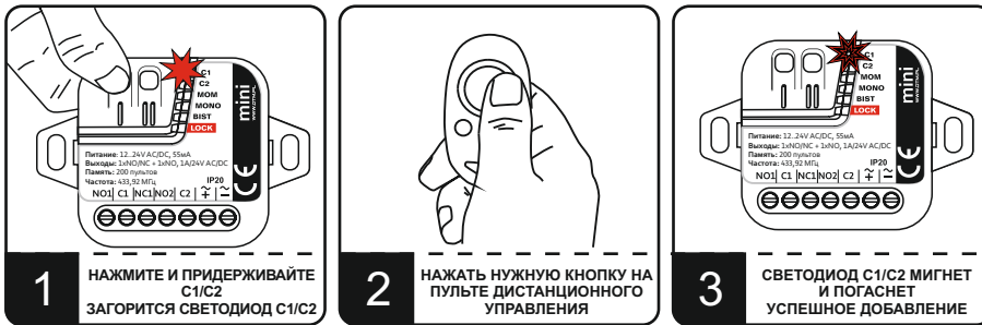
Рис. 2. Добавление пульта дистанционного управления в память приемника.
