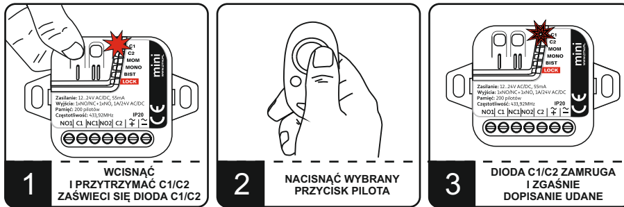
Rys. 2. Wpisywanie pilota do pamięci odbiornika.
