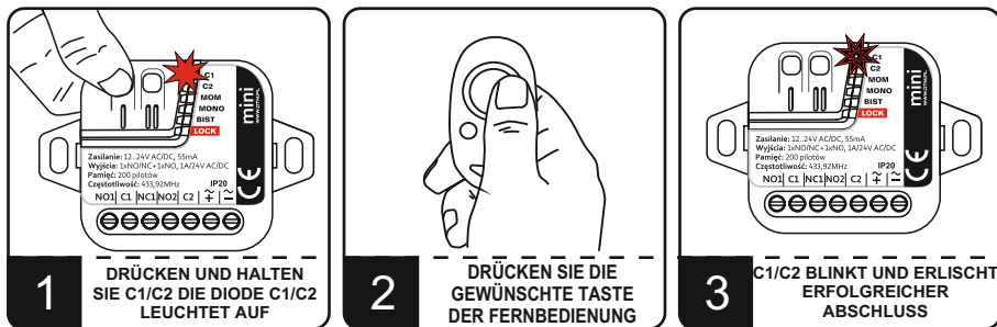
Abb. 2. Eingabe der Fernbedienung in den Speicher des Empfängers
