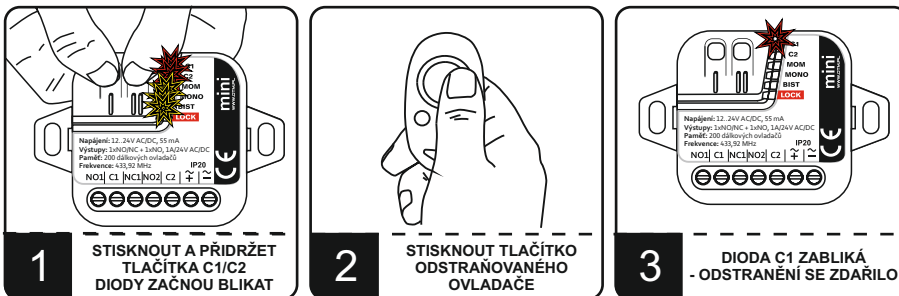
Obr. 3. Odstranění ovladače z paměti přijímače.
