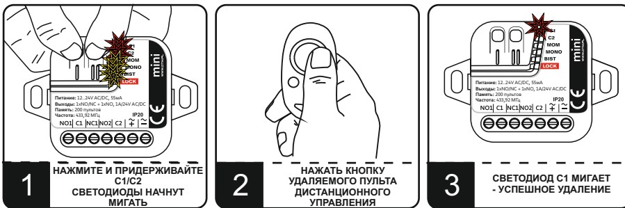
Рис. 3. Удаление пульта из памяти приемника.
