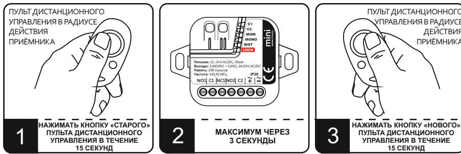
Рис. 4. Дистанционное добавление пульта дистанционного управления.
