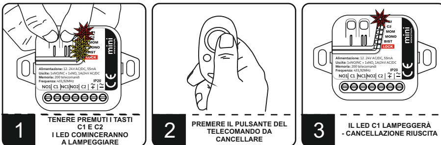
Fig. 3. Cancellazione del telecomando dalla memoria del ricevitore.
