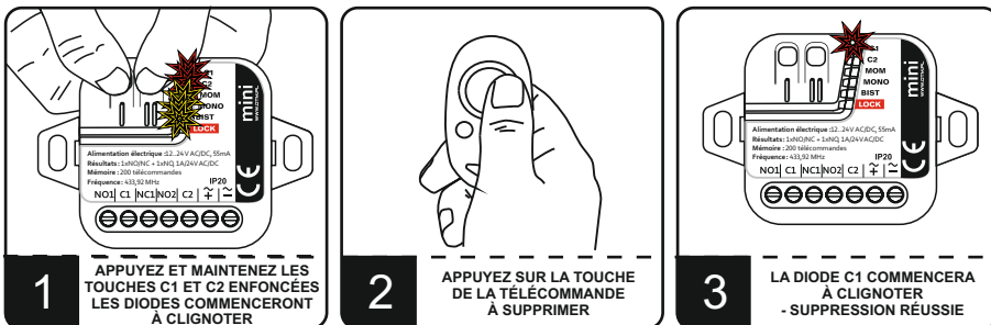
Fig. 3. Suppression de la télécommande de la mémoire du récepteur.
