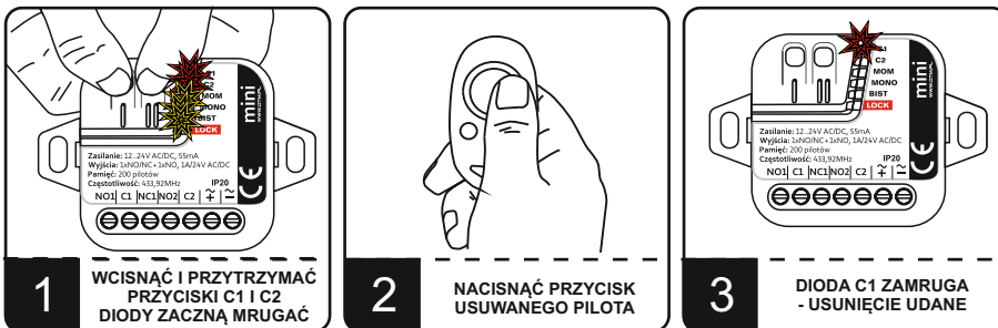
Rys. 3. Usuwanie pilota z pamięci odbiornika.
