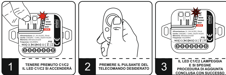
Fig. 2. Inserirlo del telecomando nella memoria del ricevitore
