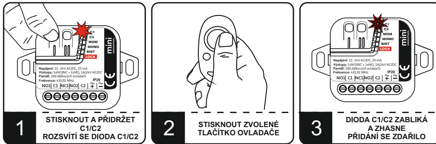
Obr. 2. Přidání ovladače do paměti přijímače.
