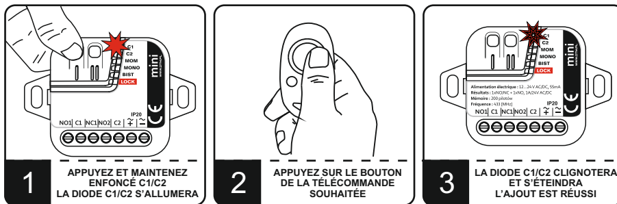
Fig. 2. Saisie de la télécommande dans la mémoire du récepteur.
