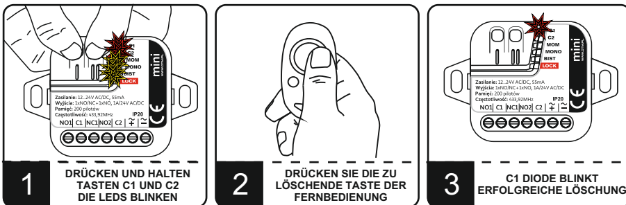
Abb. 3. Entfernen der Fernbedienung aus dem Speicher des Empfängers.
