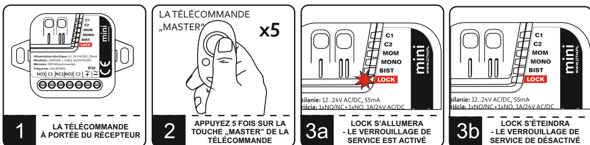
Fig.7. Activation/ désactivation du verrouillage de service.
