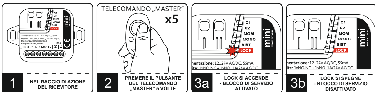
Fig.7. Accensione/spegnimento del blocco di servizio.
