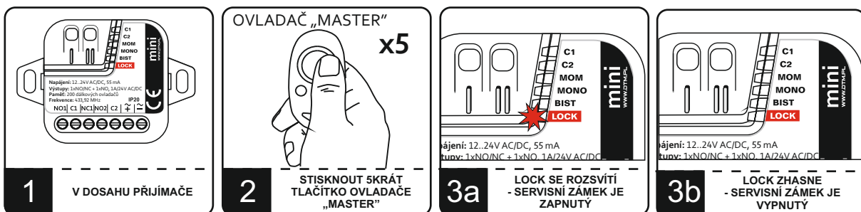
Obr. 7. Zapnutí/vypnutí servisního zámku.
