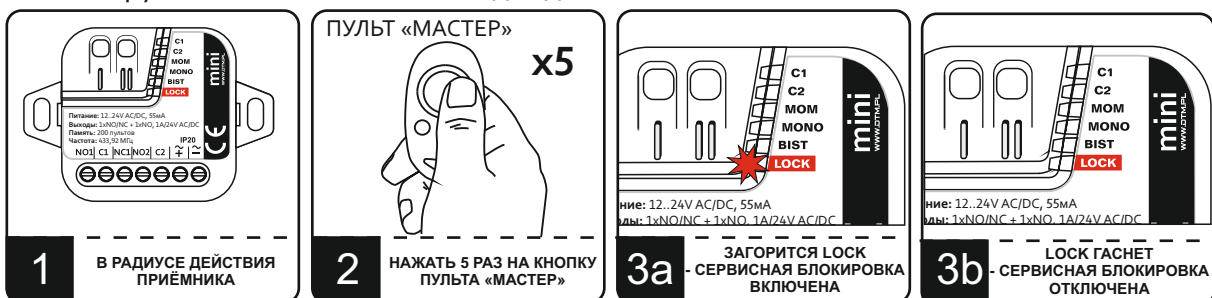
Рис. 7 Включение/выключение сервисной блокировки.
